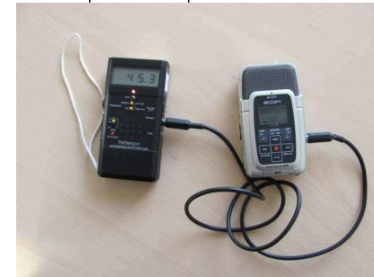
PETTERSSON D240X couplé à un enregistreur numérique
